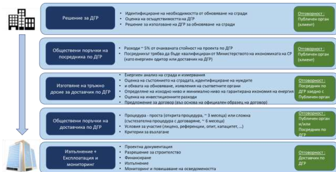
Фигура 1 Схема: процес на подготовка и изпълнение на ДГР
